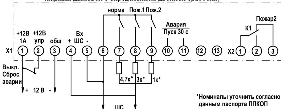
Схема подключения ИПА к ПЦН с уменьшением сопротивления ШС при формировании извещений «Пожар 1», «Пожар 2» с обобщенным сигналом о неисправности «Авария» и приоритетом формирования сигналов о пожаре
