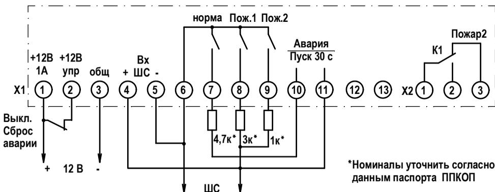
**Примечание** – При использовании приборов ПЦН с функцией перезапроса извещателей на ложное срабатывание для предотвращения сброса полученных данных о пожаре следует отключить данную функцию в приборе либо подключить клеммы X1.4(VxШС+) и X1.5(VxШС-) ИПА к источнику питания 12 В.
