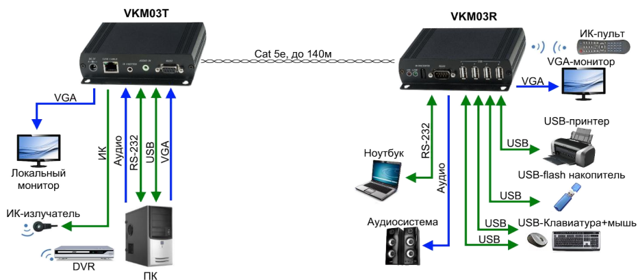
Рис.7 Подключение передатчика VKM03T и приёмника VKM03R
