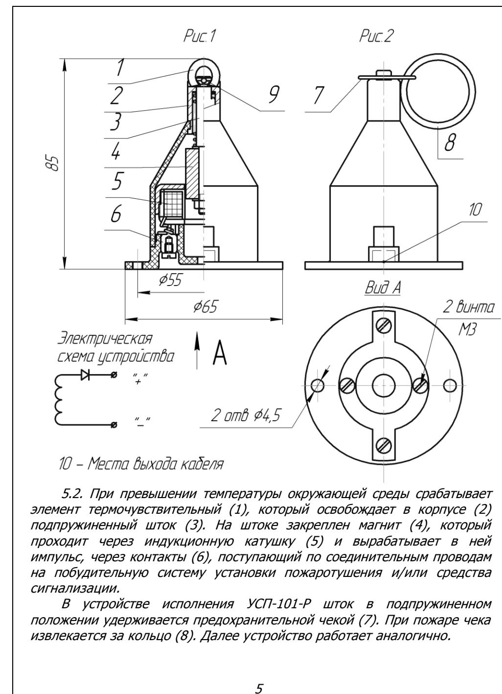
5.2. При превышении температуры окружающей среды срабатывает элемент термочувствительный (1), который освобождает в корпусе (2) подпружиненный шток (3). На штоке закреплен магнит (4), который проходит через индукционную катушку (5) и вырабатывает в ней импульс, через контакты (6), поступающий по соединительным проводам на побудительную систему установки пожаротушения и/или средства сигнализации.
