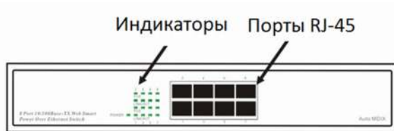
Рис. 4 Индикаторы и разъемы. Коммутатор SW-20800/B , вид спереди
