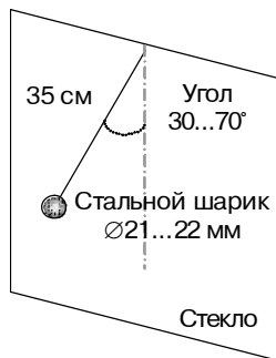
Рисунок 43. Нанесение имитационного удара по стеклу при настройке извещателя
