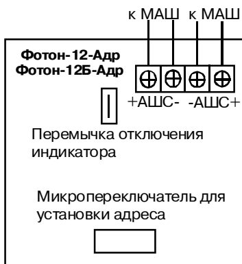
Рисунок 23. Схема внешних подключений извещателя
