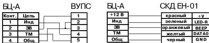
Рисунок 6 - Схемы подключения ВУПС к БЦ-А
