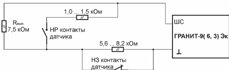
Рис.7. Схема включения технологических датчиков в ШСТ.
