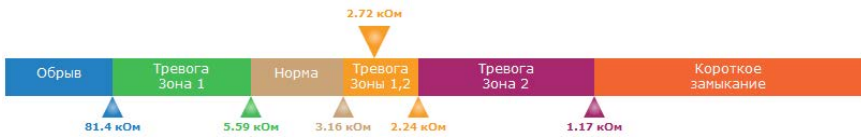
Рисунок 23. Шкала порогов охранного шлейфа
