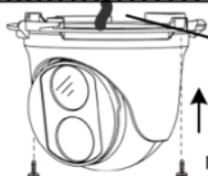
Подключите кабель и изолируйте его водостойкой изоляционной лентой
