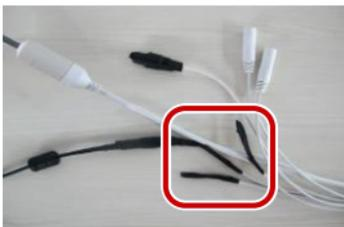
4. Обмотайте все ответвительные кабели изоляционной лентой.
