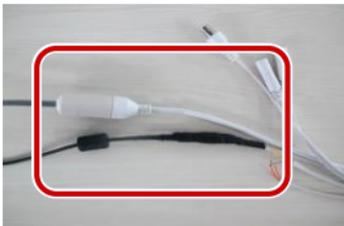
3. Обмотайте остальные кабели изоляционной лентой.
