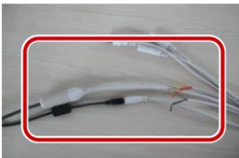
2. Обмотайте соединённые кабели изоляционной лентой.
