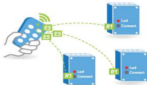
A-1b Подключение передатчика к 3 приемникам
