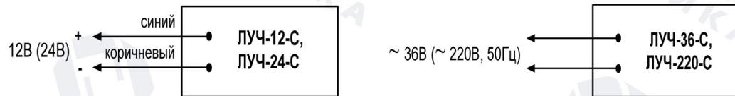
Рис.1. Схемы подключения.
