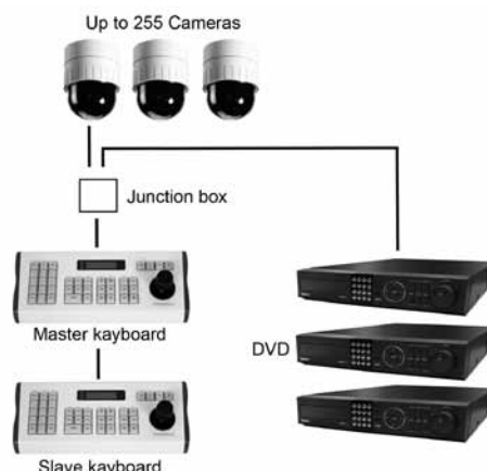
Типовая схема подключения STT-CN3R1
