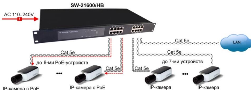
Рис. 4 Схема подключения коммутатора SW-21600/HB
