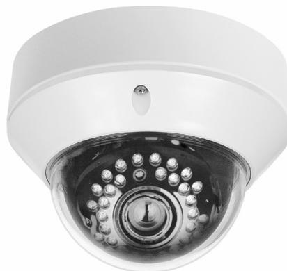
IP-камера STC-IPM3570 Харо использует 1/2.8'' 2-мегапиксельную КМОП-матрицу Sony Exmor™ совместно с процессором обработки сигнала XARINA™, обеспечивающим особо высокий фреймрейт (до 50к/с) и реализацию функции широкого динамического диапазона (120дБ) на основе двойного сканирования. Высокий фреймрейт дает возможность детально рассмотреть видео от динамичных объектов, в то время как широкий динамический диапазон позволяет использовать камеру в условиях особо контрастного освещения.
