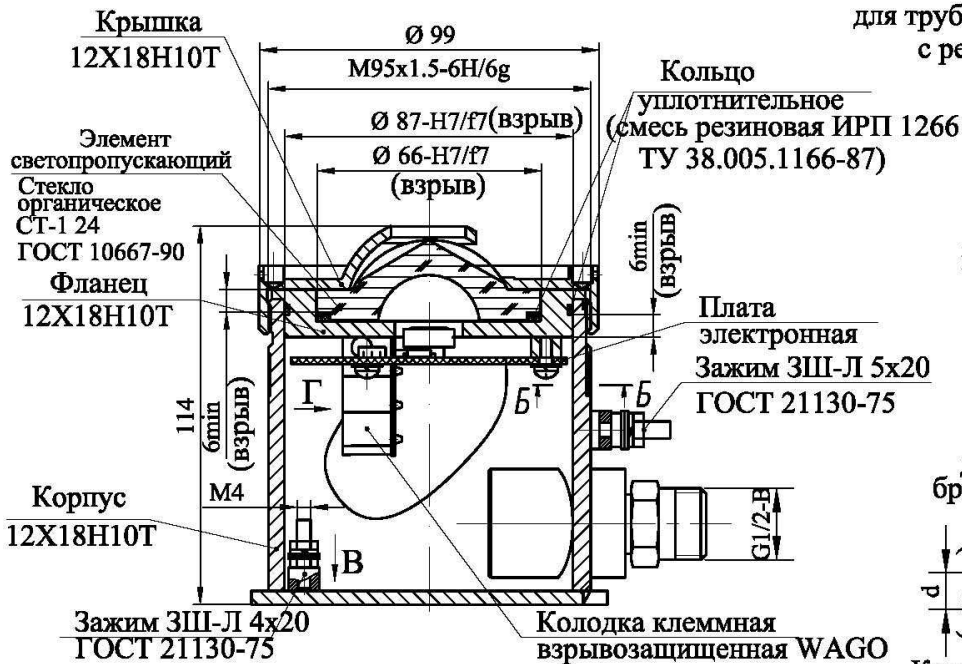
Рис. А.5 Габаритный чертёж Оповещателя ExОППС-1В-Р в стальном корпусе, совмещённый с чертежом взрывозащиты
