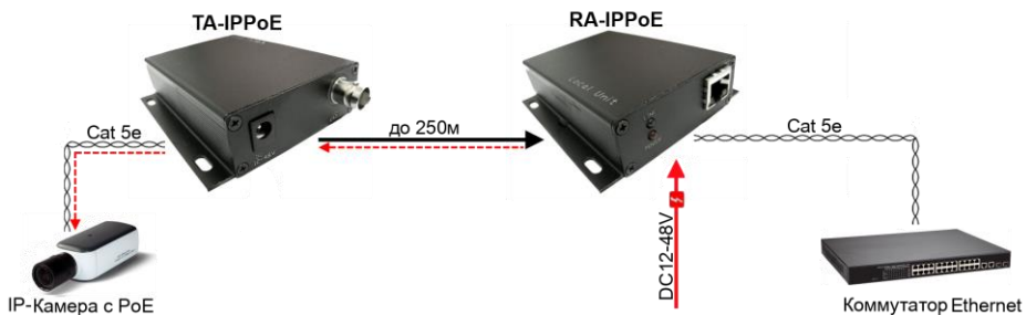
Рис. 6 Схема подключения устройств TA-IPPoE + RA-IPPoE с питанием от блока питания.
