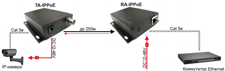
Рис. 7 Схема подключения устройств TA-IPPoE + RA-IPPoE в режиме сплиттера, с питанием от БП
