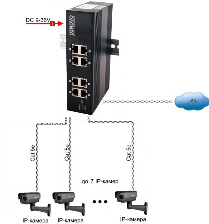
Рис.5 Типовая схема подключения коммутатора SW-70800/I
