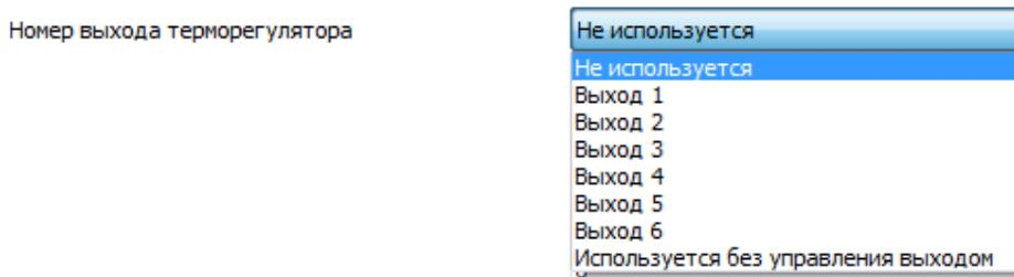
**Внимание! Если в качестве терморегулятора зоны используется трёхходовой кран, то для управления им используется два выхода. Для вращения в сторону открытия тепла используется выход, указанный в настройках. Для вращения в сторону перекрытия тепла используется выход с номером, указанным в настройках. ПЛЮС для этих выходов должен быть ОДИН.**
