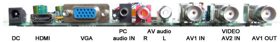
**DC:** Используйте только источник питания 12 В постоянного тока, входящий в комплект монитора.
