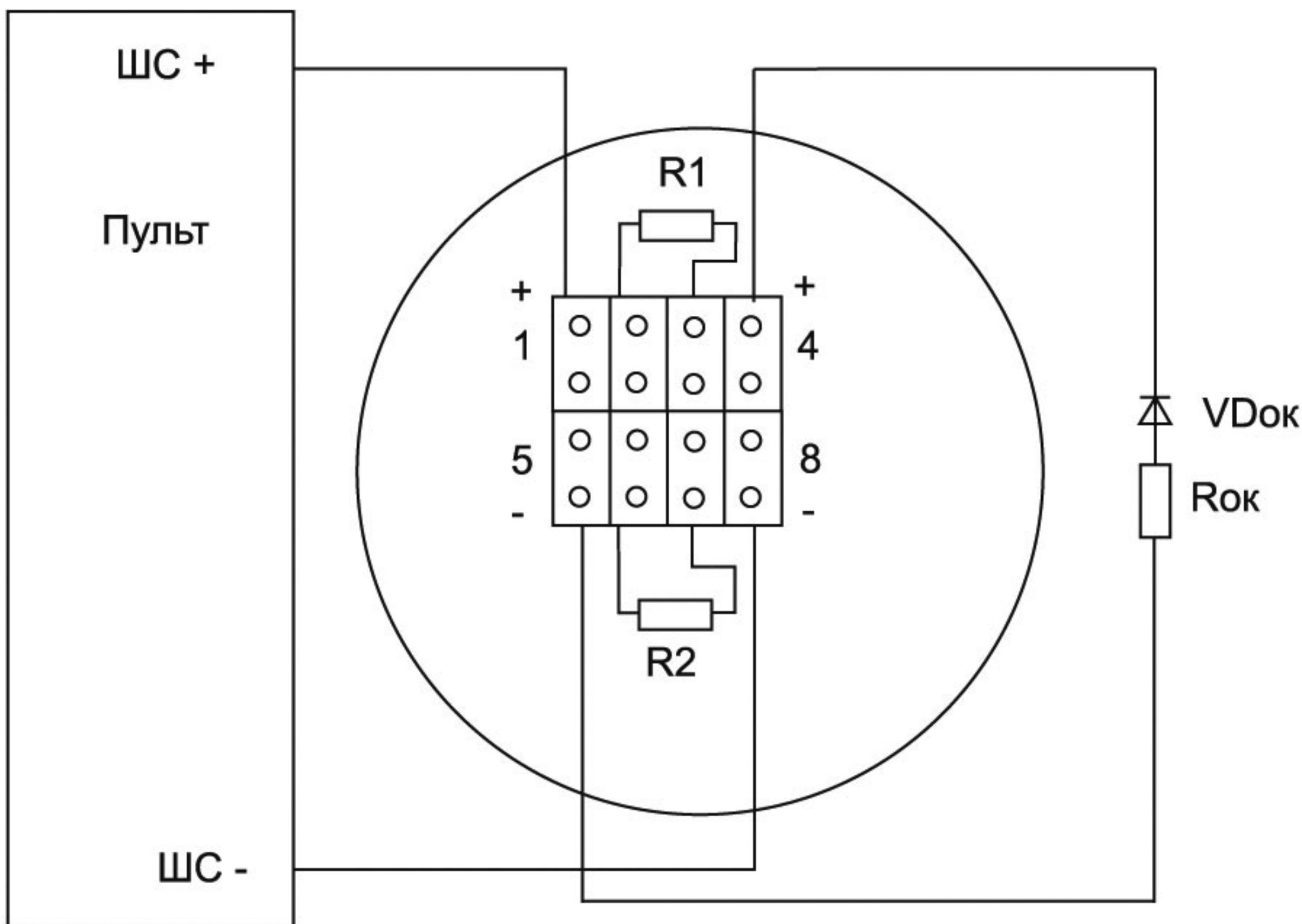
R1 резистор, устанавливаемый при параллельном включении извещателей в шлейф
