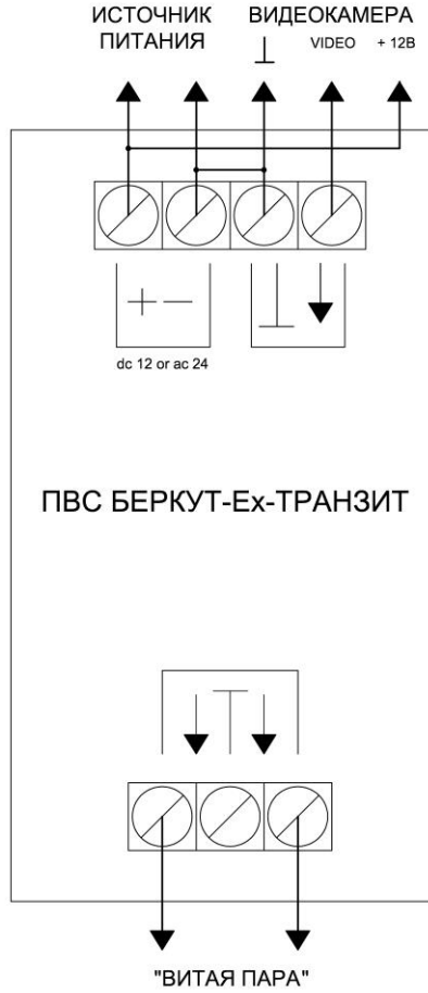
Рис. П-1 Схема подключения передатчика видеосигнала «Беркут-Ех-Транзит»
