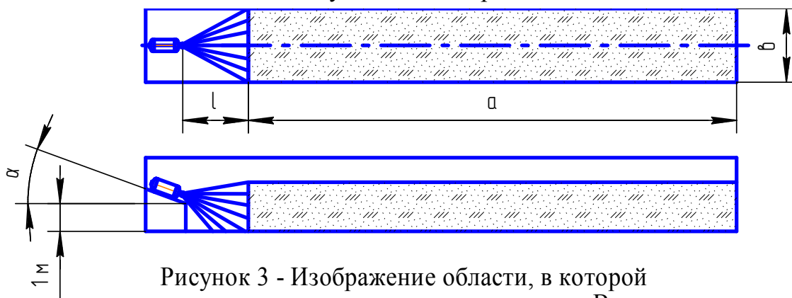
Рисунок 2 - Изображение области, в которой достигается тушение пожара класса А
