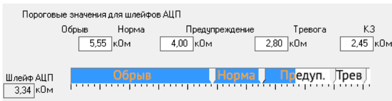
Рисунок 11. Шкала порогов пожарного шлейфа при сработке 1 датчика
