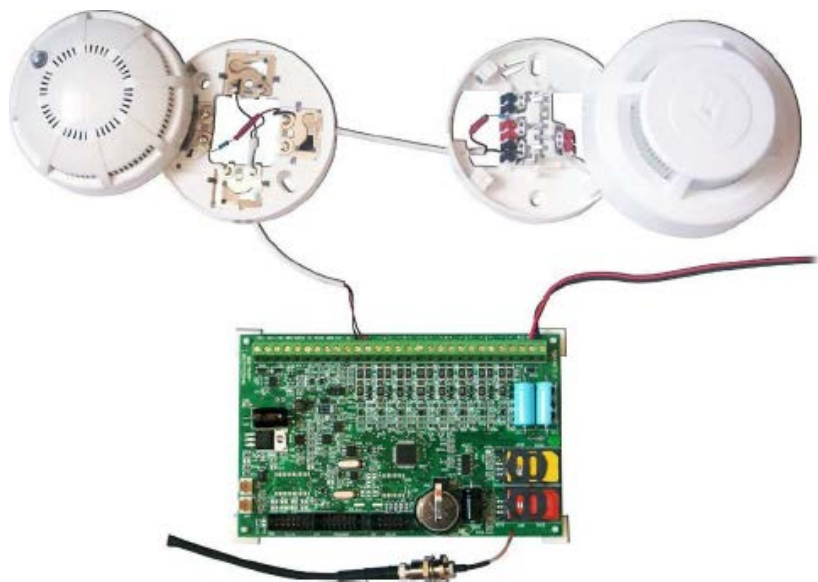
Рисунок 35. Фотография подключения двух пожарных датчиков
