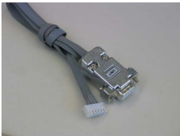
Рисунок 17 - Внешний вид кабеля программатора UNIT-6
