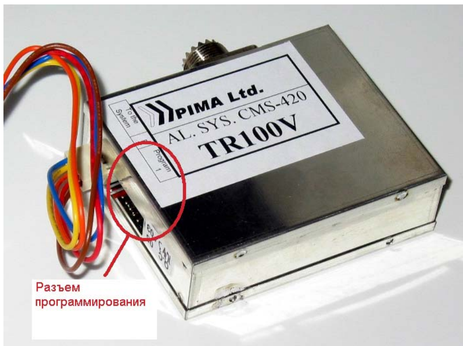
Рисунок 22 - Внешний вид разъема программирования радиопередатчика TRV-100
