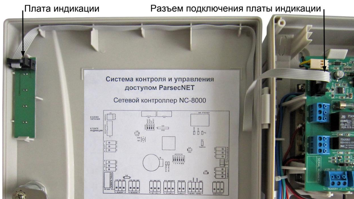
Рисунок 25. Подключение платы внешней индикации
