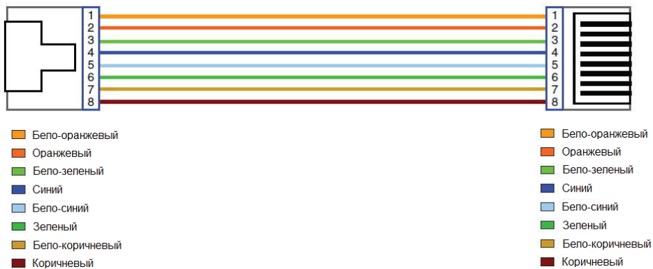
Рис. 8 Разводка кабеля по типу TIA/EIA-568-A.
