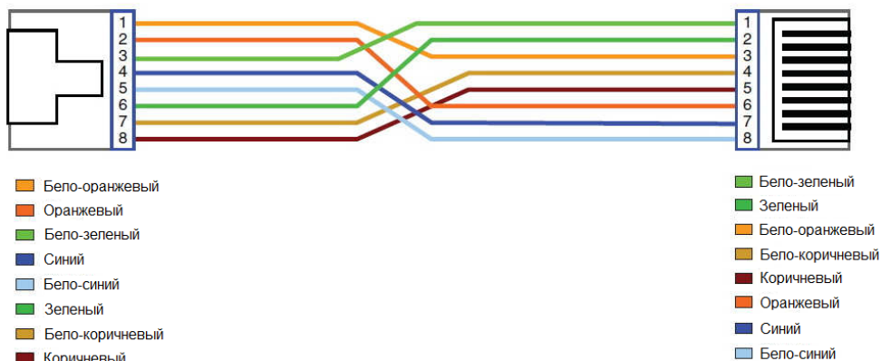
Рис. 9 Разводка кабеля по типу TIA/EIA-568-B.
