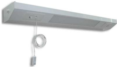
Светильник консольного типа ЛБО 08М состоит из двух частей - верхней и нижней: верхняя часть предназначена для общего, а нижняя для местного освещения палат больниц, госпиталей и других медицинских учреждений. В верхней части светильника используется одна люминесцентная лампа 36 Вт и стартер на 220 V, а в нижней части две люминесцентные лампы по 18 Вт и два стартера по 127 V.
