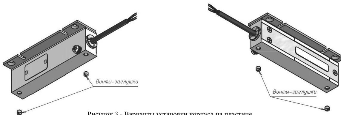
Рисунок 3 - Варианты установки корпуса на пластине
