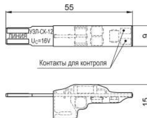
Рис.1 Габаритные размеры УЗЛ-СК-12 (УЗЛ-СК-24)
