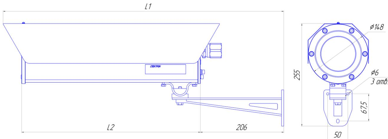
Рисунок 1 – Габаритные размеры термокожуха с крепежно-юстировочным устройством
