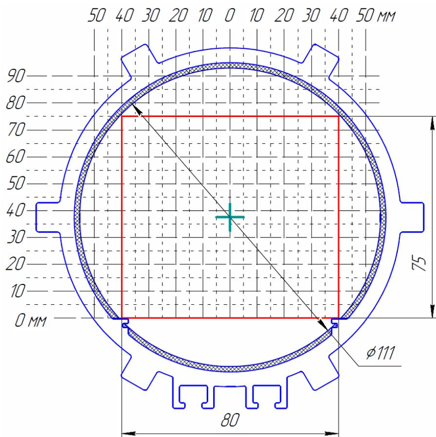
Рисунок 2 – Сечение термокожуха.
