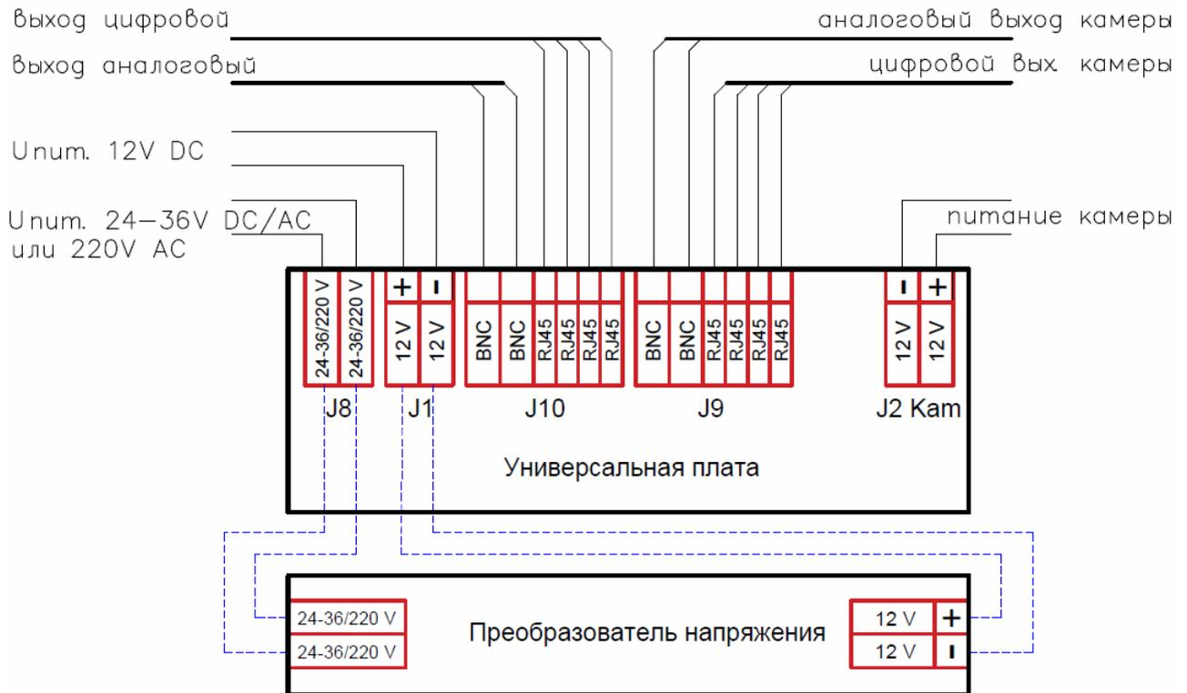
Рисунок 4 – Схема подключения термокожуха и встраиваемого оборудования
