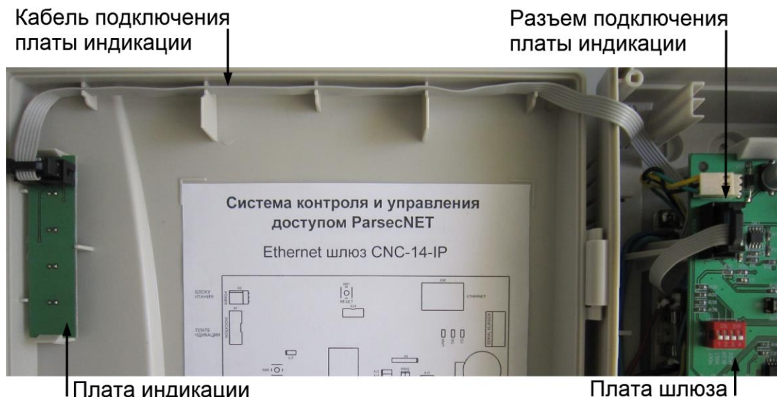
Рисунок 11. Подключение платы индикации
