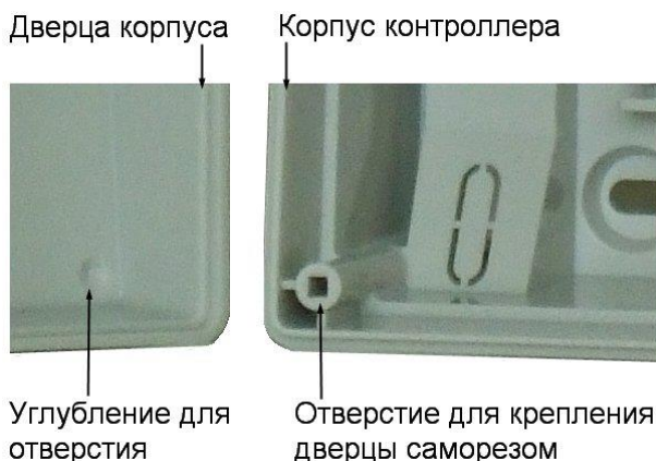
Рисунок 7. Схема «жесткого» крепления дверцы к корпусу
