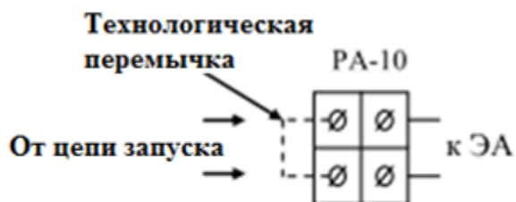
Рис.2 - Схема подключения ТРВ-Гарант вар. 1 с ПШК общего пользования
