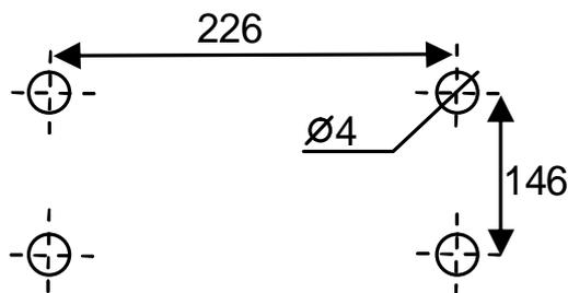
Рисунок 7 – Разметка крепления
