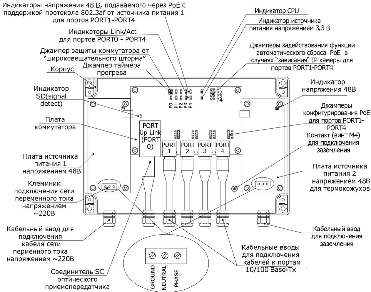
Рисунок 1 - Расположение элементов коммутатора PSW -1
