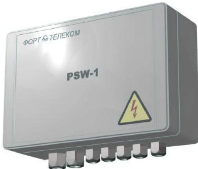
Коммутатор PSW-1 по функциональности объединяет в одном корпусе: медиаконвертер, коммутатор, PoE инжекторы, сторожевые таймеры, модули грозозащиты, схему подогрева, два блока питания.
