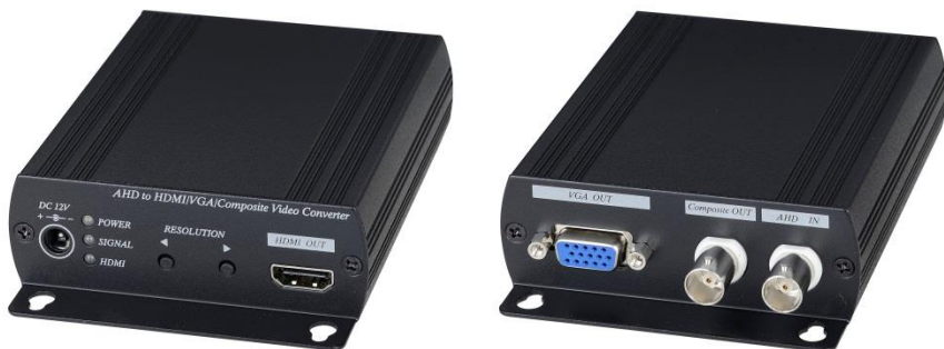
Рис. 1 Преобразователь-разветвитель AD001AHD, внешний вид спереди/сзади
