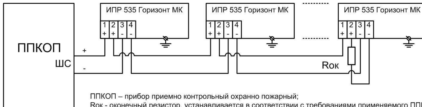
Схема включения извещателя ИПР 535 Горизонт МК в шлейф сигнализации
