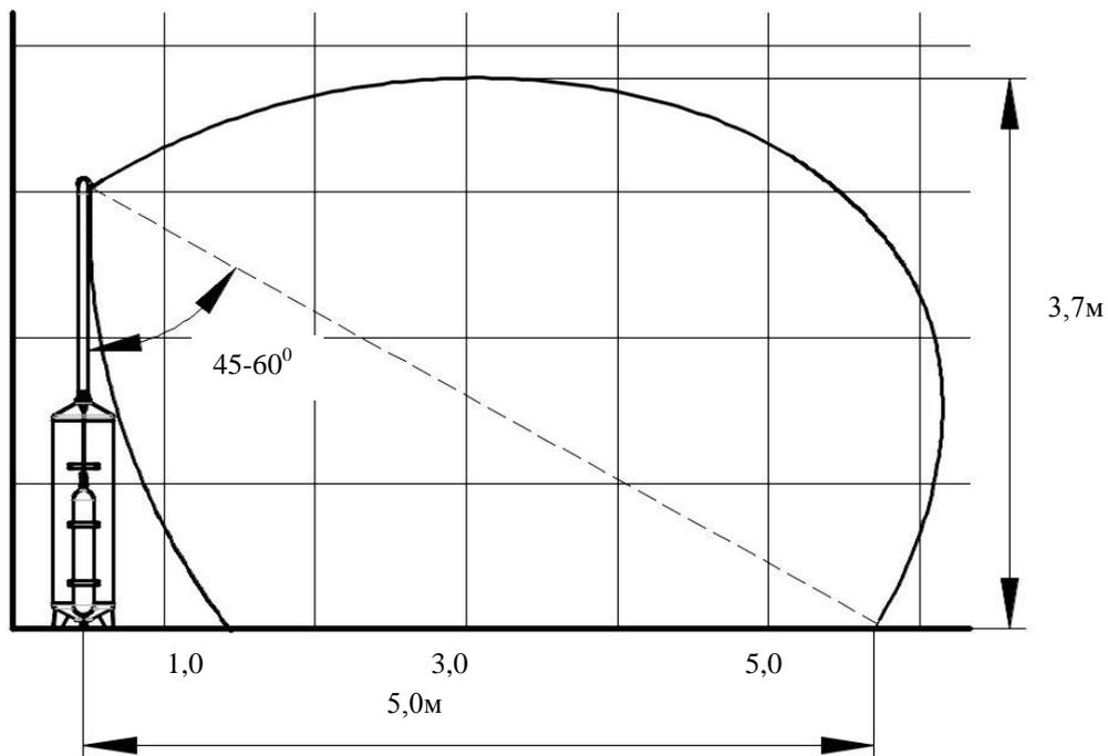
Рис.3. Диаграмма распыла насадка распылителя НС-390-С и НС-360 при подаче в интервале углов 45- 60<sup>0</sup> к горизонтальной поверхности .
