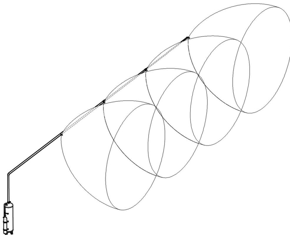
**Рис.12.Схема подачи ТРВ под углом 90° для орошения вертикальных поверхностей при горизонтальном размещении трубопровода из насадков НС-390-С или НС-360. Максимальная протяженность подводящего трубопровода составляет : для ТРВ-Гарант-160-10 не более 25м., включая вертикальную часть не более 8 м., ТРВ-Гарант-160-40 не более 70 метров, включая вертикальную часть не более 12 метров.**
