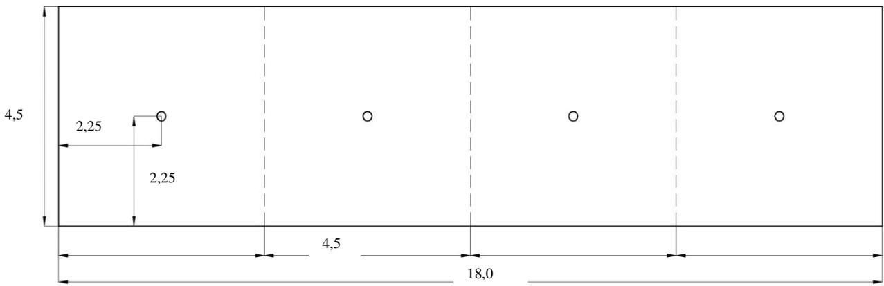
**Рис.7. Рекомендуемые схемы расположения распылителей НС-360 (симметричный распыл).**
