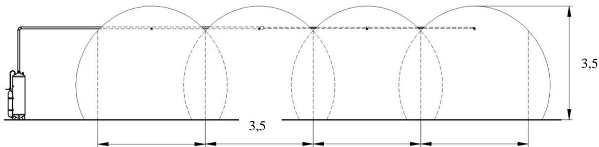
**Рис.11.Схемы орошения при подаче ТРВ в интервале углов 45-60° к горизонтальной поверхности из насадка НС 390-С или НС-360.**
