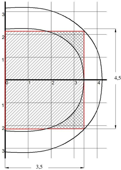
Рис.2б.Зона тушения НС-390-С(при расположении на вертикальной поверхности-стене).
