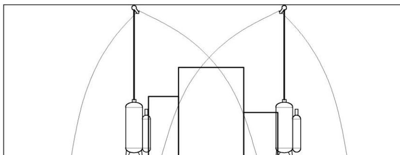
**Схема № 3. Вариант позонной защиты всей площади помещения не разделенной противопожарными разрывами и стенами.**
