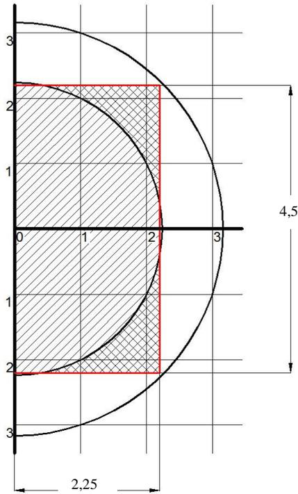
Рис. 16. Зона тушения НС-360(при расположении на вертикальной поверхности-стене).
