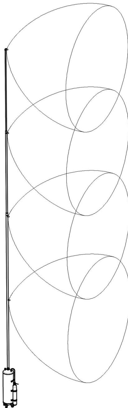
**Рис.13.Схема подачи ТРВ под углом 90° для орошения вертикальных поверхностей при вертикальном размещении трубопровода из насадков НС-390-С или НС-360. Максимальная протяженность подводящего трубопровода (вертикальная часть) составляет : для ТРВ-Гарант-160-10 не более 8м., ТРВ-Гарант-160-40 не более 12 метров.**
