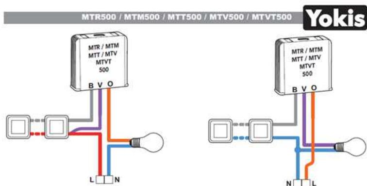
К модулю может быть подключено неограниченное количество выключателей с максимальным расстоянием 250 м между модулем и выключателем.
