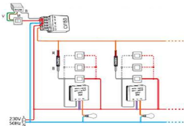
Рис.2 объединение модулей в одну шину.
