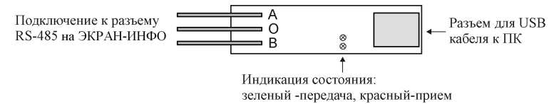
Рисунок 6. Расположение контактов преобразователя ПИ1.
