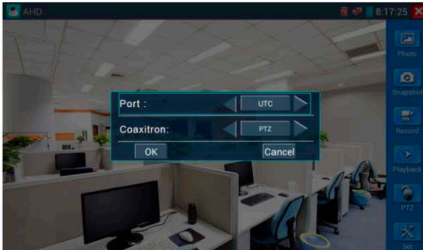
Рис.3.3.8.-3 Настройка параметров PTZ по коаксиальному кабелю
