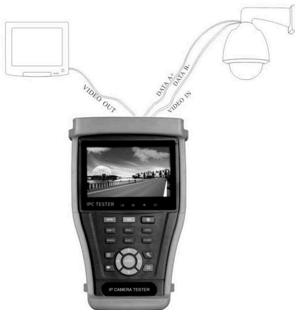
Рис 3.2.2-1 Подключение тестера к аналоговой камере.
