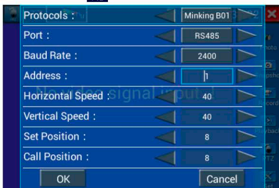
Рис.3.3.1-2 Окно настройки протокола управления камерой (RS485)
