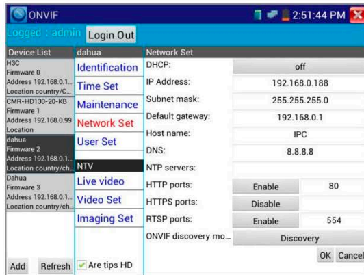
Рис.3.3.3-10 Сетевые установки (настройки IP протокола)
