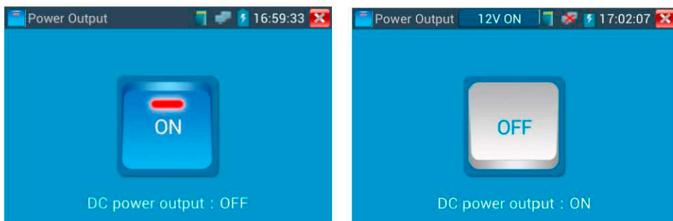
Рис.3.3.26-1 Включение и выключение выводимого питания
