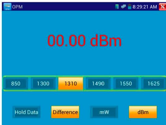
Рис. 3.3.15-2 Измерение относительной оптической мощности
