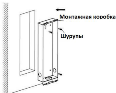
Рисунок 5-3 Установка монтажной коробки в стену
