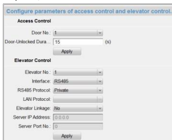
Рисунок 8-33 Меню управления доступом и настройки лифта
