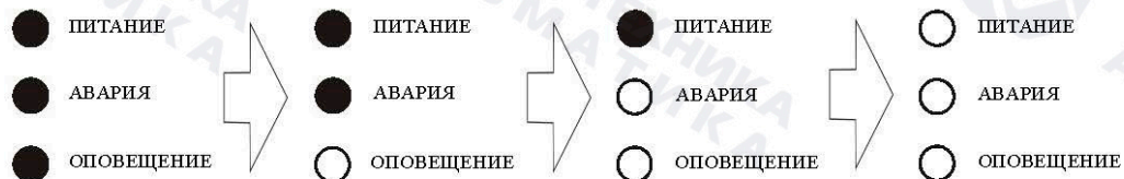
Рис.2. Индикация режима «ПРОГРАМИРОВАНИЕ» (● - горит, ○ - не горит).
