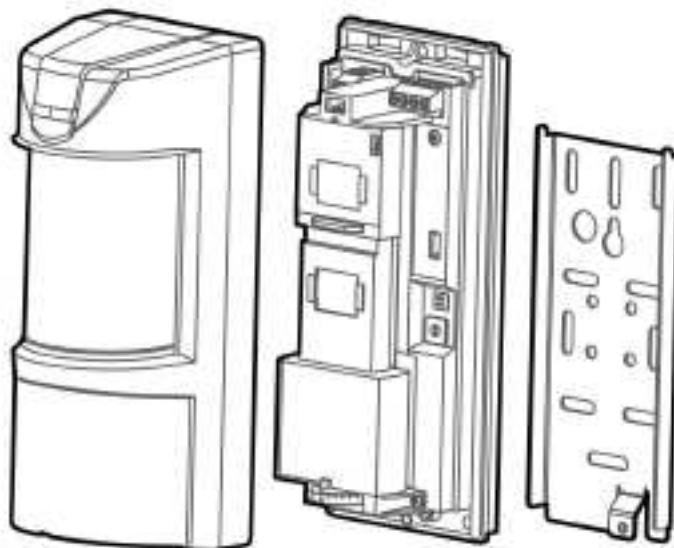
EDS-3000 является комбинацией трех извещателей: верхнего ИК, нижнего ИК и микроволнового детектора. Верхний ИК извещатель имеет регулировку по высоте, в то время, как нижний –фиксированный.
