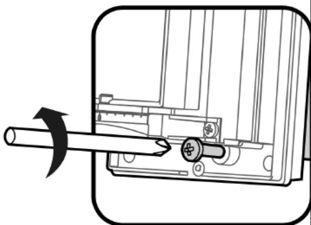
7. Снимите основание детектора с металлического кронштейна.
