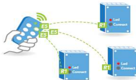
A-1b Подключение передатчика к 3 приемникам
