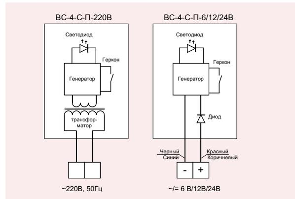
Рис. 2. Схемы соединений.
