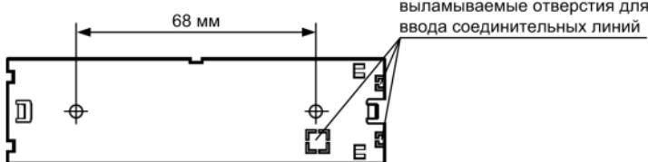
ввода соединительных линий) и закрепите основание на два самореза, прищёлкните плату, затем крышку.
