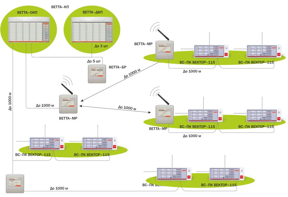
Система «ВЕТТА-2020» обеспечивает отображение на контрольных панелях информации о состоянии зон объектовых приборов. Каждой зоне охраны прибора, выбранной для отображения на контрольных панелях, ставится в соответствие канал индикации (КИ) пультового прибора. В зависимости от задач, решаемых при охране конкретных объектов, можно отображать как состояние всех зон объектовых приборов, так и выборочно, отдельно назначенных зон.
