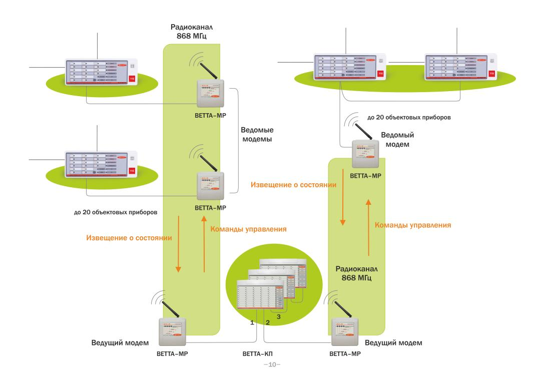
Для многих объектов удачным решением может быть обмен данными по проводному каналу по одной системной магистрали, и по радиоканалу — по другой. Такая схема дает гибкость при развертывании системы охраны объекта и поэтапное наращивание системы.
