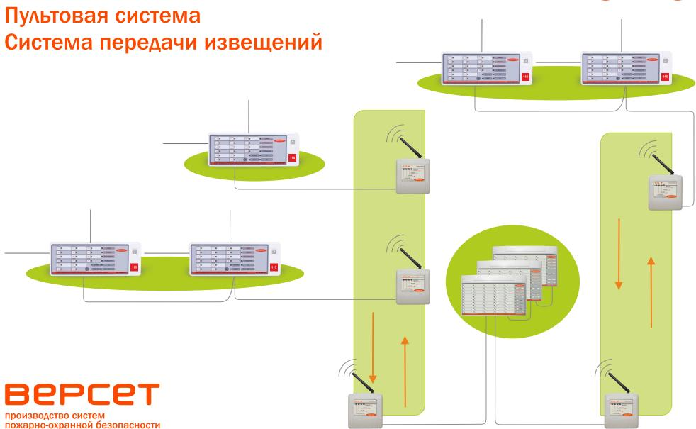
Пультовая система, система передачи извещений BETTA-2020 (далее — система) предназначена для организации охраны, пожарной охраны, оповещения о тревожных событиях на малых, средних, больших и распределенных по территории объектах.
