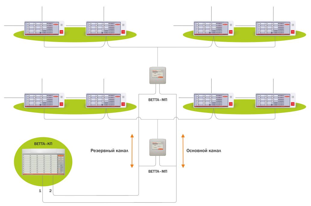
Для повышения живучести системы передачи извещений, надежности канала передачи данных, может применяться специальный режим работы системы передачи извещений «ВЕТТА-2020» — конфигурация с дублированием каналов связи.
