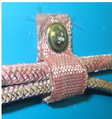
Рис. 5. Установка дюбель–хомута КФСТ.735322.041 и КФСТ.735322.164. Вариант 1.
