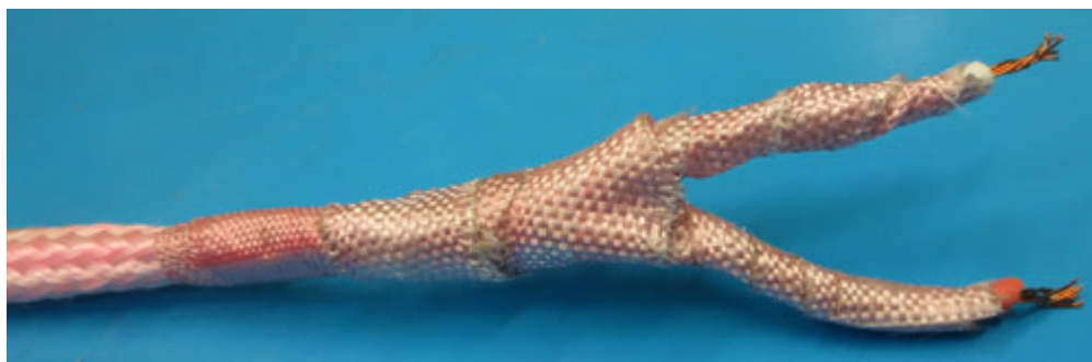
Рис. 23. Пример разделки кабеля.
