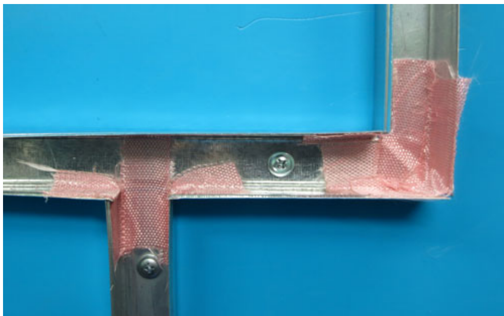
Рис. 17. Пример обработки резаных краев ККМО.
