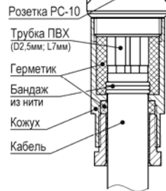
Рис.4 Распайка разъема РСГ-10ТВ
