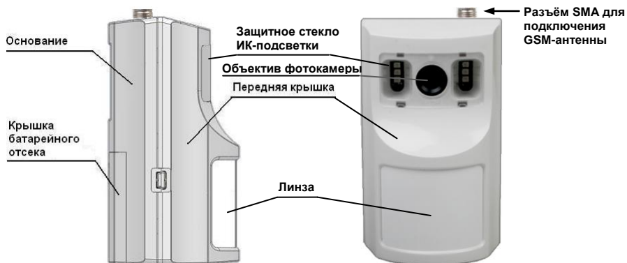
Рис.1 Конструкция сигнализатора. Общий вид
