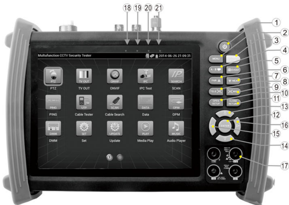
Рис. 2 Элементы экранного интерфейса и органы управления тестеров TIP, TIP-L-M, TIP-L-MT, TIP-M, TIP-MT, TIP-O-MT
