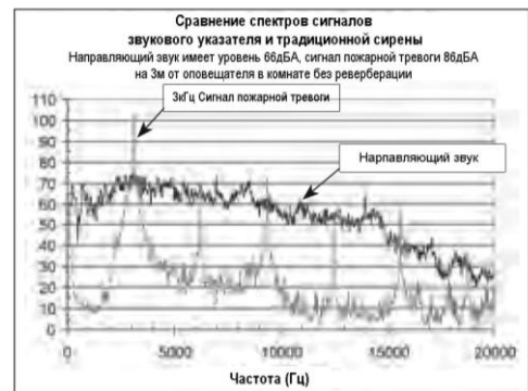
Рис. 4 Спектр звуковых сигналов традиционного оповещателя и звукового указателя
